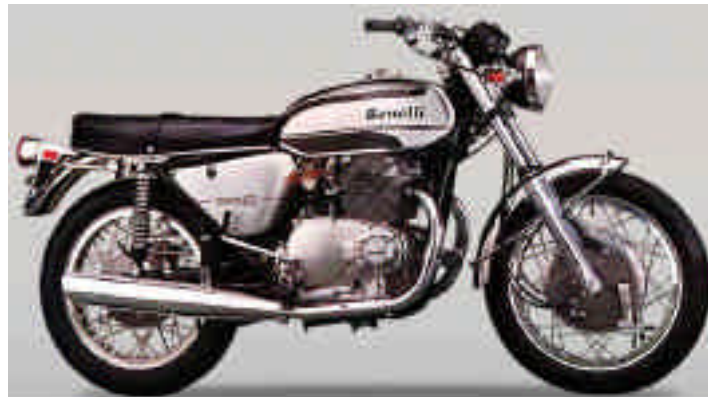
➤ 1970'lerin Benelli Tornado'su - 650 cc, 4 zamanlı, 2 silindirdir, 50HP ,hava soğutmalı, 5 vitesli, 190km/h son sürati olan motorsiklet...
