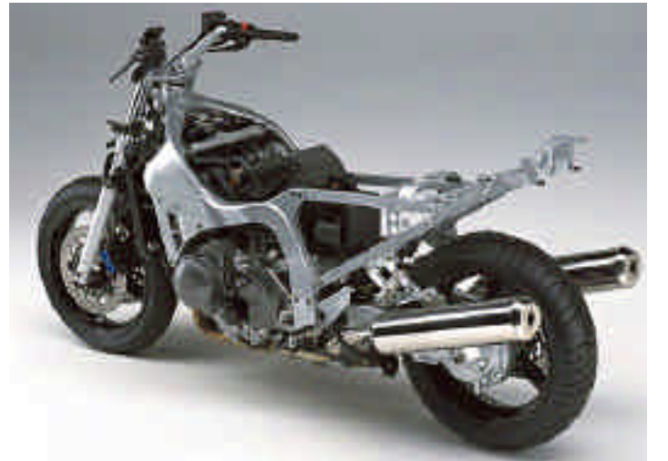
➤ Hafif alüminyum şase, toplam kuru ağırlığın 273kg olmasında önemli bir etken.
