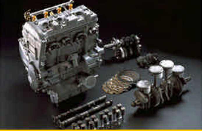
➤ FJR 1300 motoru - 1,298cc, sıralı 4 silindir ve 16 sübap, elektronik ateşleme ve enjektörlü yakıt sistemi
