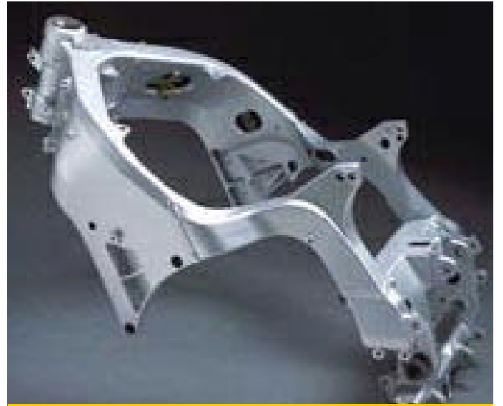
➤ FJR şasesi - Alüminyum. Sağlam, sürüş geometrisine yardımcı ve en önemlisi gerçekten hafif.
