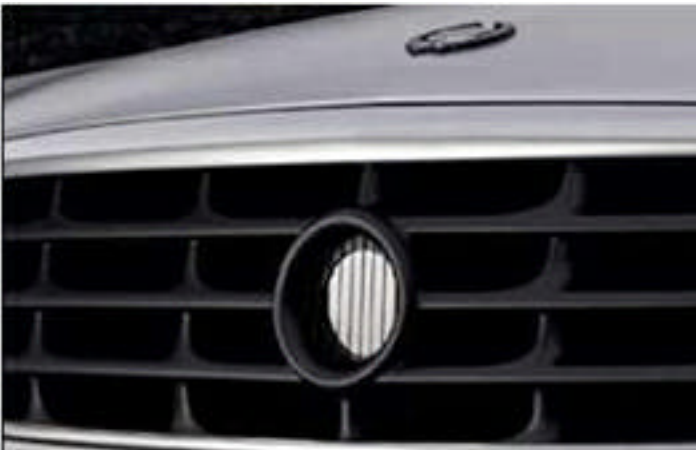
➤ Resim 1. Cadillac DeVille ön ızgarasına yerleştirilen termal kamera lensi. www.cadillac.com
