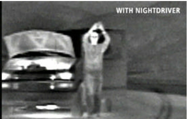
➤ Resim 6. Karşıdaki farlar çok sıcak olmadığı için termal kameraların görüntüsünü engellemez. www.nightdriver.com
