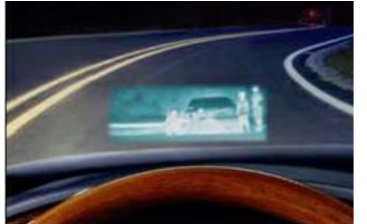
➤ Resim 2. Ön camdan yansıtılan termal kamera görüntüsü. www.raytheoninfrared.com
