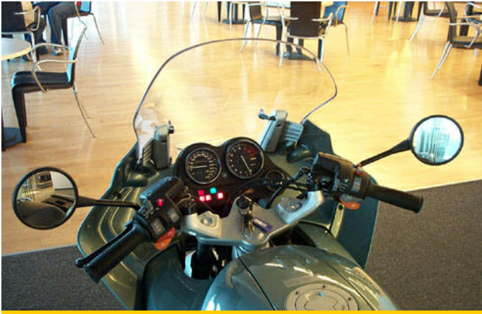
➤ Gösterge tablosu, RS'den farklı olarak ön cam elektrik ayarlı, ön kollar ayarsız.
